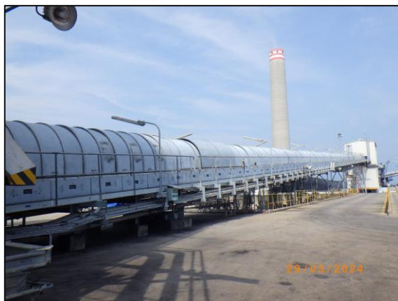
รูปที่ 2-5 การปิดคลุมสายพานลำเลียงถ่านหินบริเวณท่าเทียบเรือ ยกเว้นสายพานบริเวณหน้าท่า
