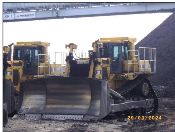
รูปที่ 2-11 การจัดเตรียมรถลูโตเซอร์เพื่อใช้บดอัดถ่านหิน
